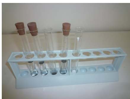
Obr. 2: Rozličné podmienky hrdzavenia železa
